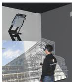
Un système immersif à l'échelle 1 permettant à l'utilisateur de percevoir les grandeurs en jeu dans l'environnement et d'interagir avec celui-ci. Il pourra ainsi se déplacer dans des bâtiments, en changer par exemple les matériaux pour en constater les conséquences aussi bien sur l'éclairage à l'intérieur du bâtiment que sur le niveau sonore.
